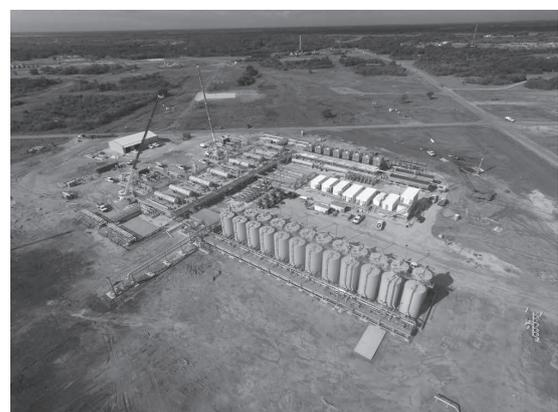
写真1 ウェスト・ランチ油田で生産原油・CO<sub>2</sub>・水の分離処理などを行う施設
