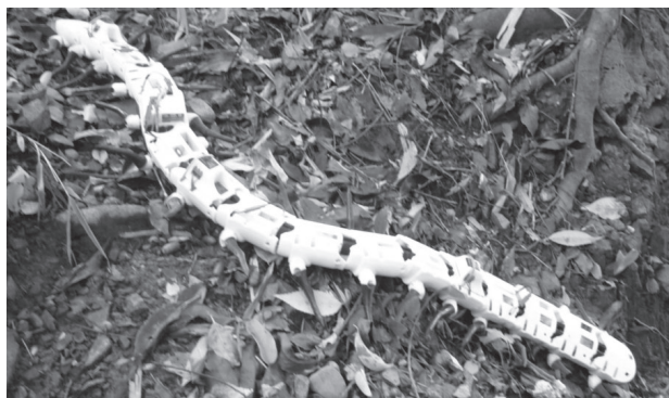
図4 ムカデロボット i-CentiPot
