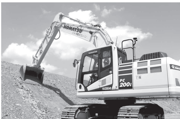
写真2 ICT油圧ショベル
