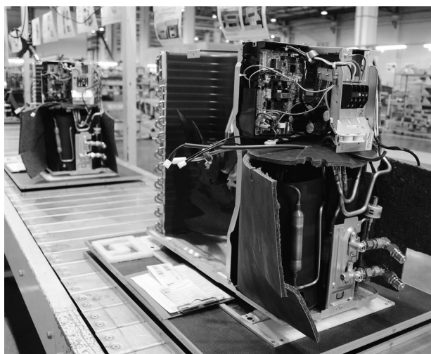
室外機の組み立て工程
