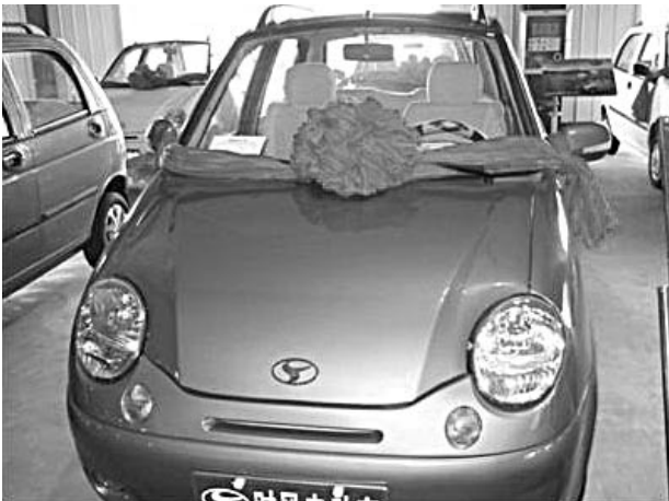
農村の結婚式パレード用として人気の電気自動車、後部に鉛電池を搭載している
